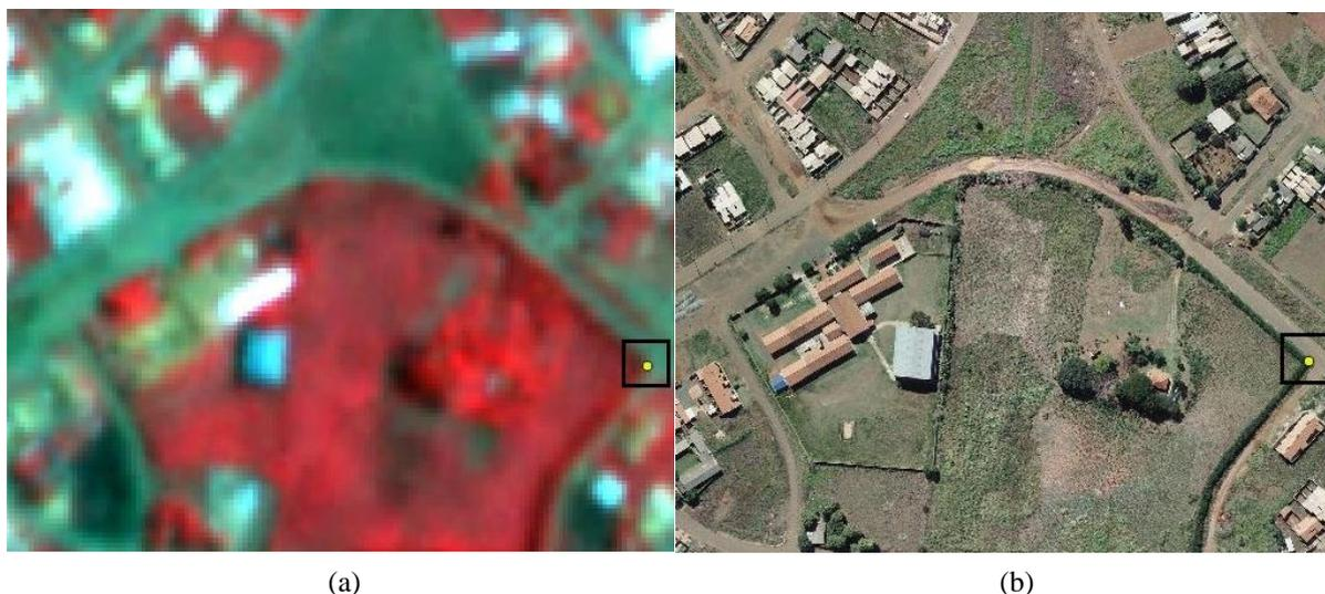
Figura 13: Medição de pontos correspondentes no QGIS: (a) Imagem Planet (GSD de 3,7 metros); (b) Ortoimagem aérea (GSD de 10 cm). Fonte: Própria autora.
