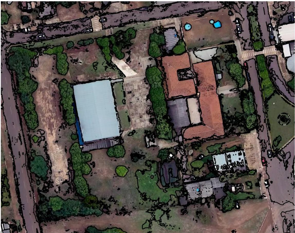
**Figura 13:** Segmentação realizada no *software* Monteverdi da quadra 02. Também há uma boa separação dos objetos, com os mesmos problemas da quadra 01.
